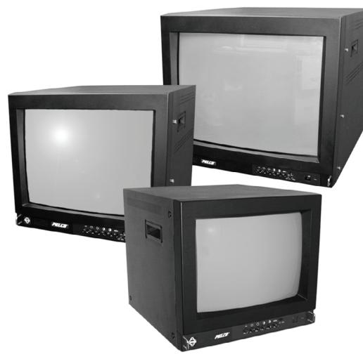
如果您要求高清晰的图像, Pelco 的超高分辨率监视器将是您最佳的选择。PMCS15A, PMCS17A 和 PMCS19A 监视器都具有计算机级标准的显像管, 能够达到 700/800 TVL 的水平分辨率。标准的高分辨率监视器只能产生约 350 TVL。
