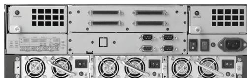
**DX9200HDDI** 视频存储单元包含可存储来自 DX8000/DX8100 数字视频录像机或 NVR300 网络视频录像机的视频信息的硬盘。每个单元都可按下面两种方法中的一种进行配置：RAID 5 或者 RAID 5 + 热备份。RAID 5 可在硬盘发生故障时提供保护作用，因为丢失的数据可以通过奇偶校验驱动器上的可用数据来重建。而 RAID 5 + 热备份则增添了一层额外的保护，因为在 RAID 阵列中配置和添加了一只“热备份驱动器”。
