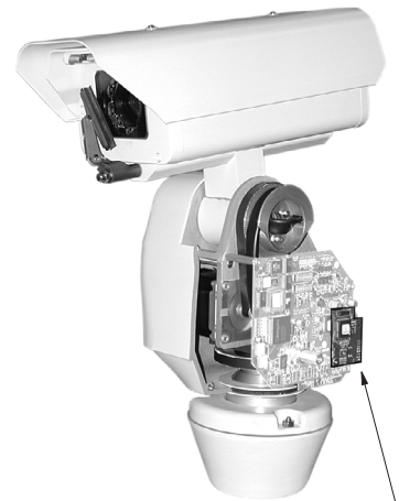
TXB-AD 译码板 (安装于 ESPRIT ES31C 系列一体化定位系统 (侧盖已卸))
